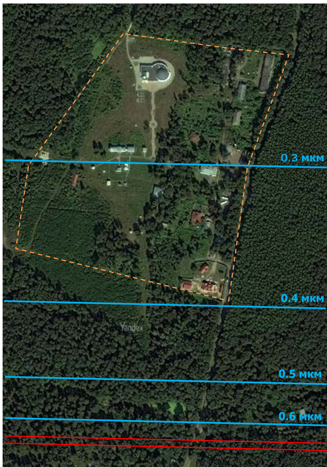
Рис. 16. Расчет максимальных средних квадратических смещений поверхности грунта при прохождении поезда со скоростью 350 км/ч в окрестности Астрономической обсерватории
