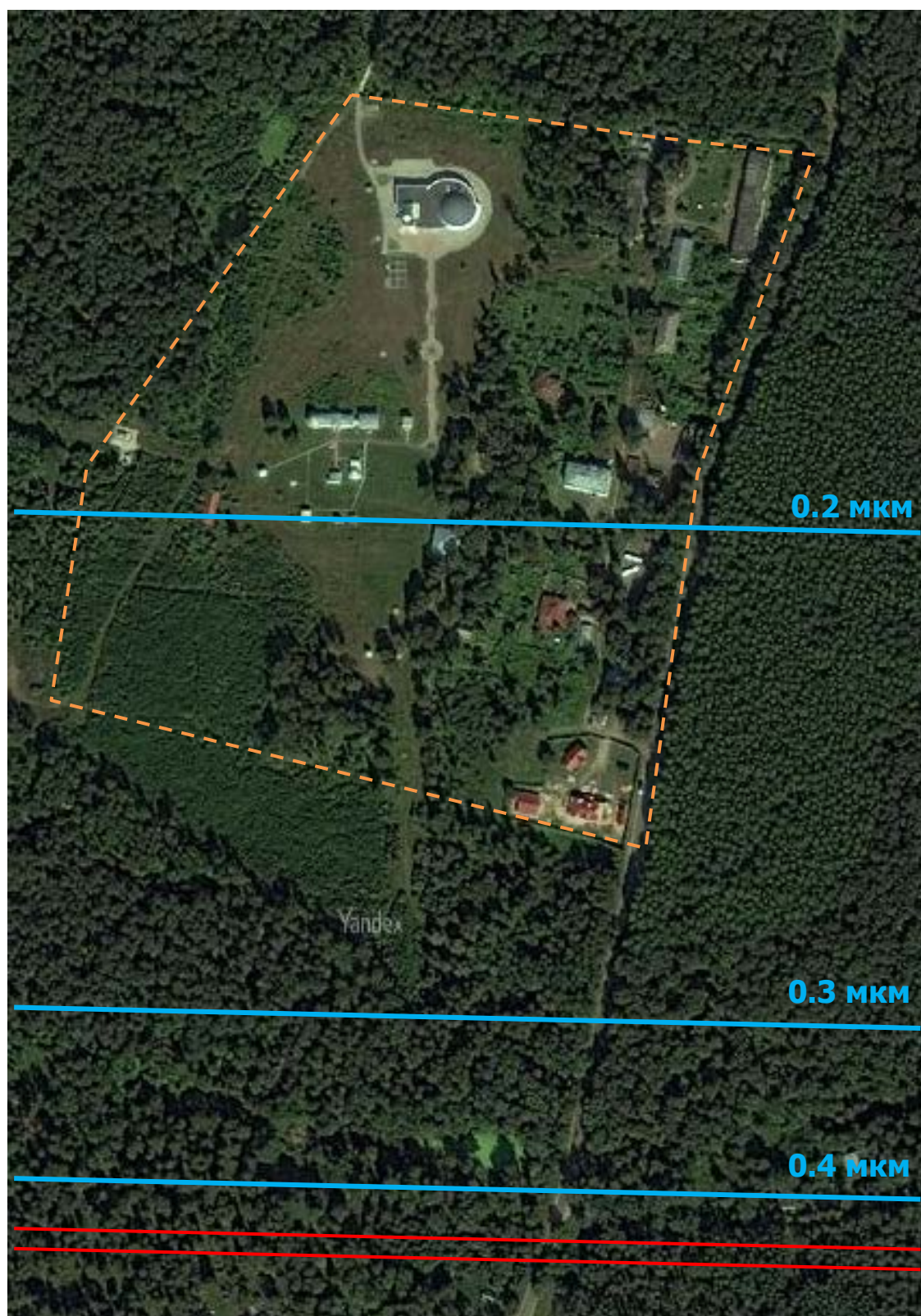
Рис. 15. Расчет максимальных средних квадратических смещений поверхности грунта при прохождении поезда со скоростью 300 км/ч в окрестности Астрономической обсерватории
