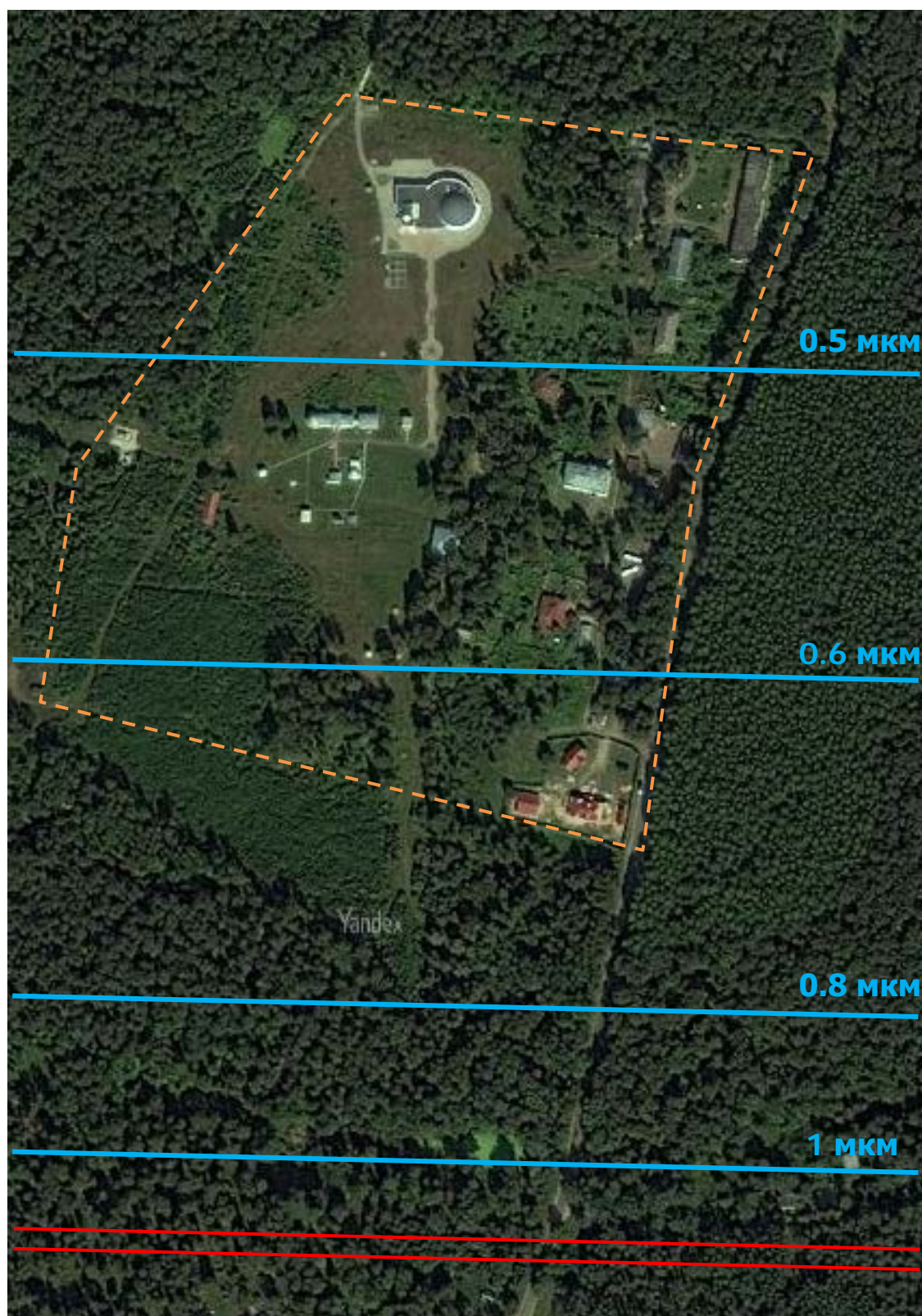
Рис. 17. Расчет максимальных средних квадратических смещений поверхности грунта при прохождении поезда со скоростью 400 км/ч в окрестности Астрономической обсерватории
